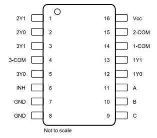
Figure 4-6. Pin Diagram SOT-23-THIN Package
