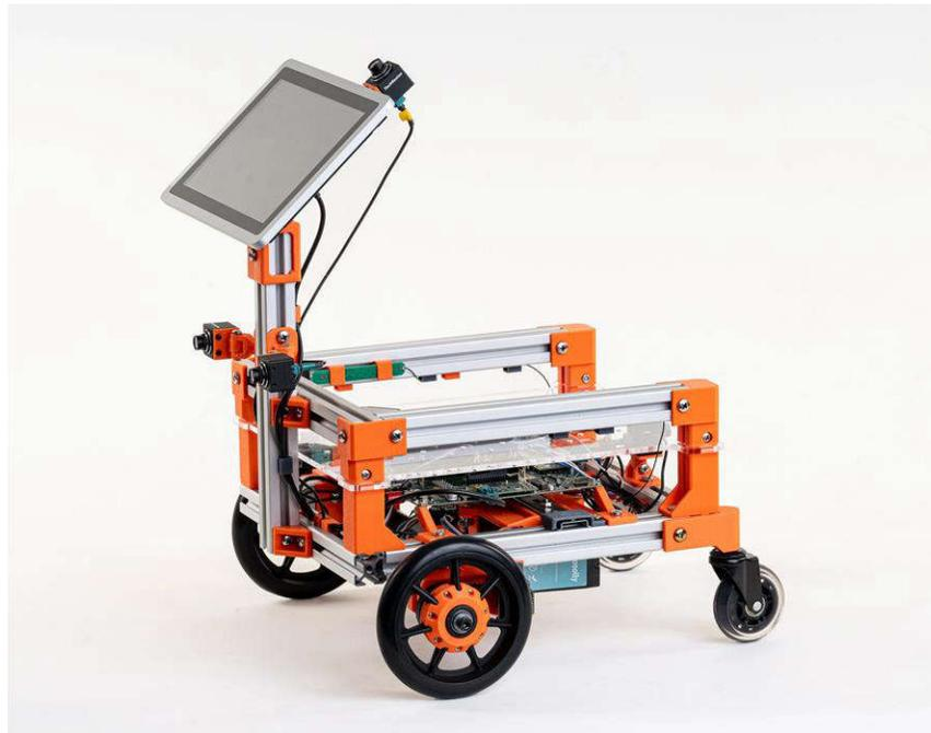
그림 2. TechNexion “Rovybot” AMR 데모, ROVY-4VM-EVK(새시 포함)
