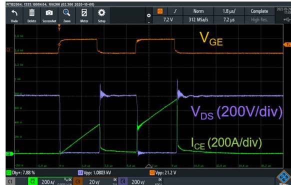
그림 5-6. 0.5Ω 게이트 저항을 사용하는 강한 드라이브
