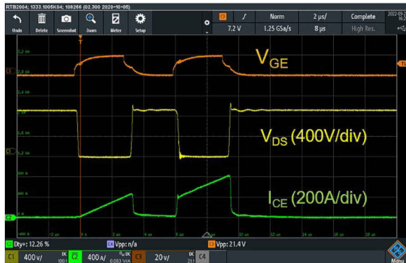
그림 5-5. 5.5Ω 게이트 저항을 사용한 약한 드라이브
