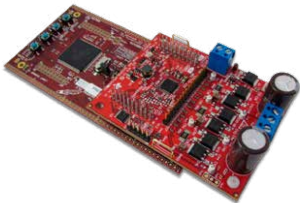
図3：DRV3245Q-Q1車載3相モーター・ゲート・ドライバの評価基板 (BOOSTXL-DRV3245AQ1)。
