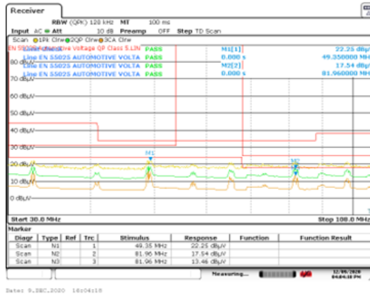
图 4. 隔離式 5V 參考設計 (有交錯層) 傳導式排放與 CISPR 25 Class 5 的比較，30 到 108MHz：以 4.5dB 容限通過，最糟的情況為 82MHz 「CISPR 平均」偵測結果。來源：德州儀器
