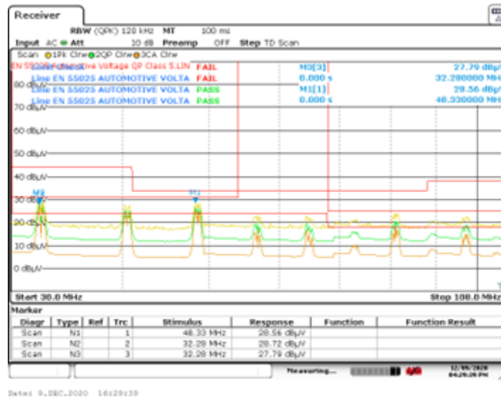
图 5. 未發佈電路板 (無交錯層) 傳導式排放與 CISPR 25 Class 5 的比較，30 到 108MHz：以 3.8dB 容限不通過，最糟的情況為 32MHz 「CISPR 平均」偵測結果。來源：德州儀器
