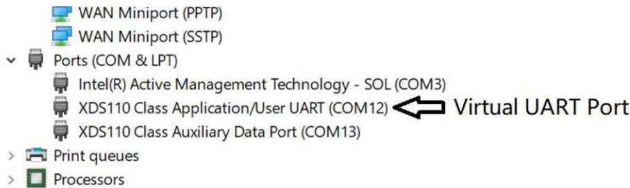
図 2-2. PC または携帯電話の GUI 上の仮想 UART ポート
