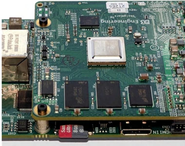
図 3-2. Micro SD カードを TDA3x システムに挿入
