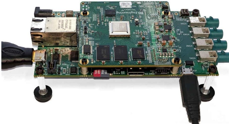
図 3-3. HDMI Mini を TDA3x システムの HDMI OUT ポートに接続
