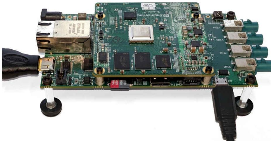
図 3-1. シリアル・コンソール・デバッグ・ポートに接続された USB Micro B ケーブル
