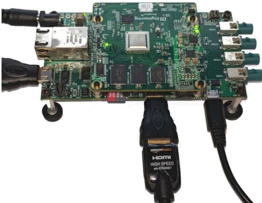
**図 3-5. TDA3x システムを電源に接続**
