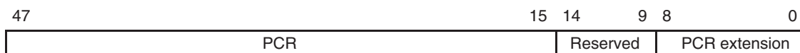
図 3-23. プログラム・クロック・リファレンス (PCR) のヘッダ・フォーマット
