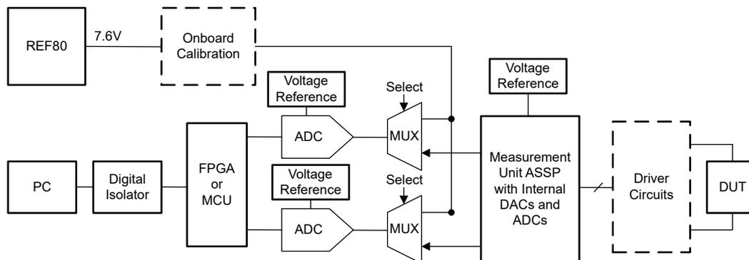
図 3. 自動試験装置内にあるパラメータ測定ユニットのブロック図
