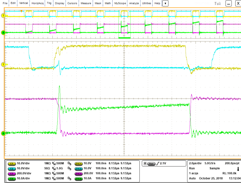
図 8-6. SiC MOSFET のスイッチング波形
