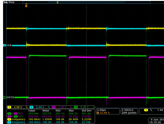
図 8-5. INA/B と OUTA/B のベンチ テスト波形
