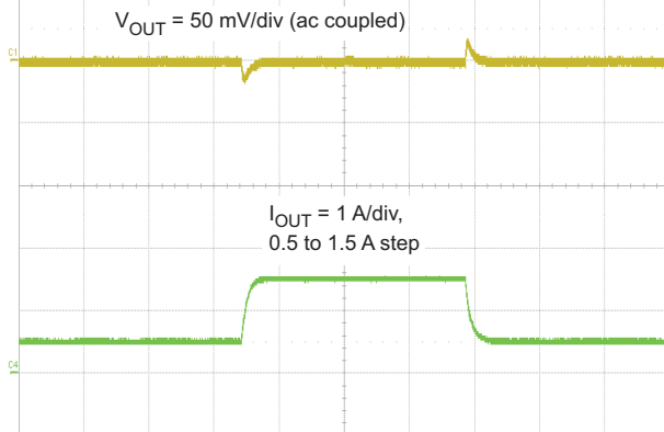
Time = 2 ms/div 1-A Load Step
