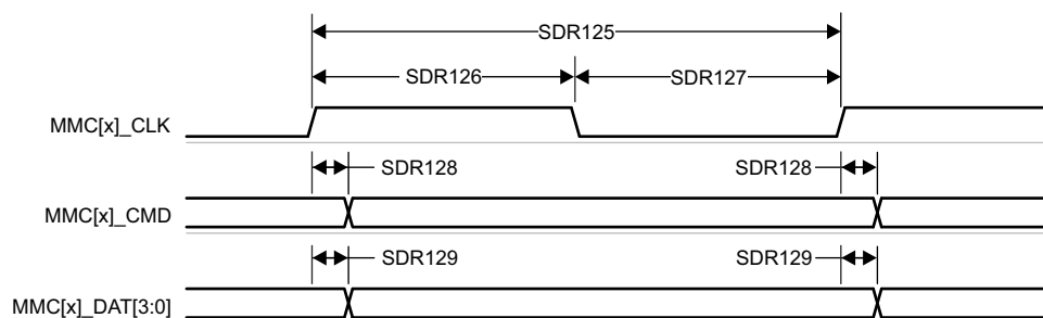
図 6-91. MMC1/2 – UHS-I SDR12 – 送信モード
