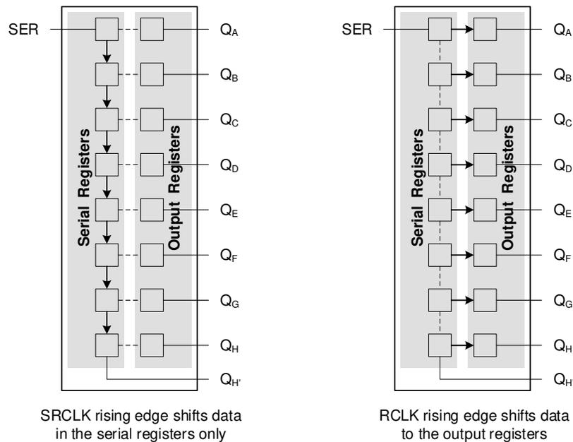
図 8-2. クロック動作を示す概略機能図
