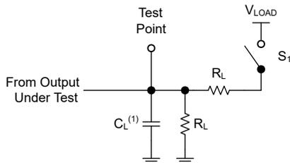
(1) C<sub>L</sub> にはプローブとテスト装置の容量が含まれます。
