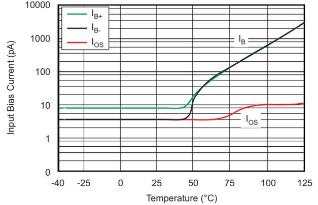
図 5-8. 入力バイアス電流と温度との関係
