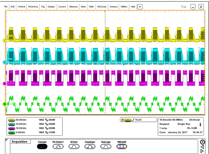
図 55. BLDCモーター整流、2000RPM
