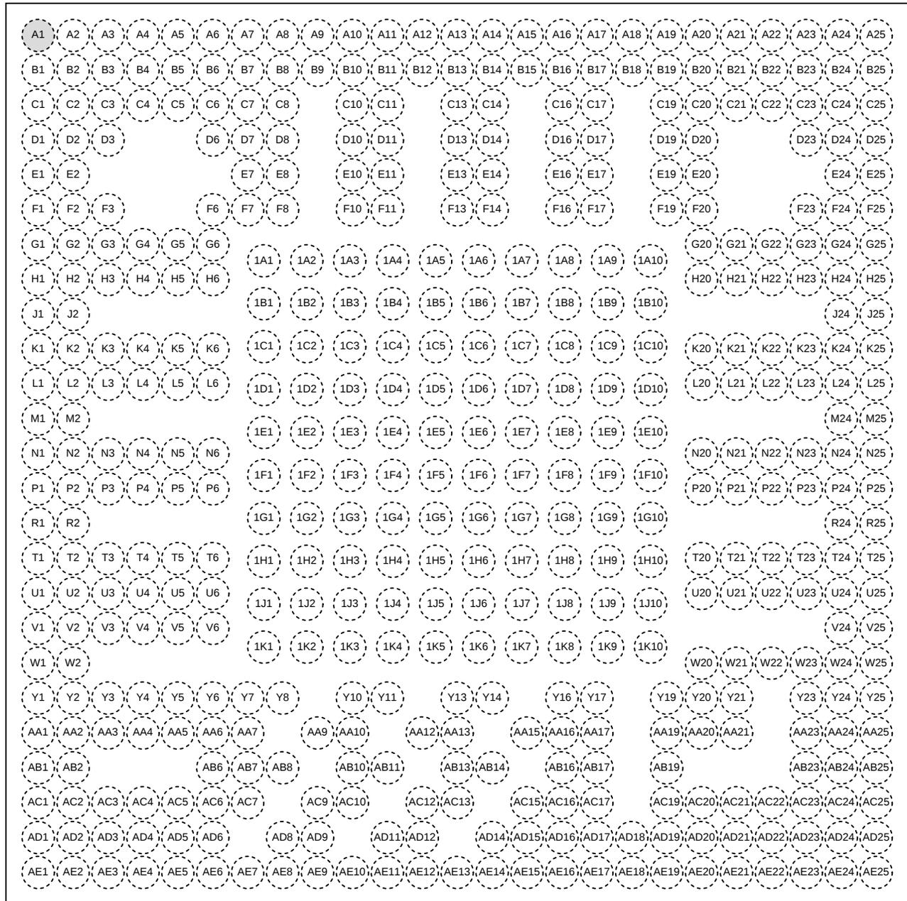
図 5-1. AMH FCBGA-N のピン配置図 (上面図)
