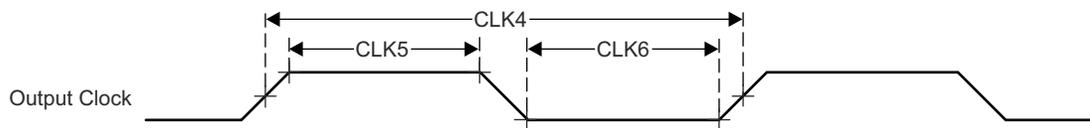
図 6-15. クロックのスイッチング特性
