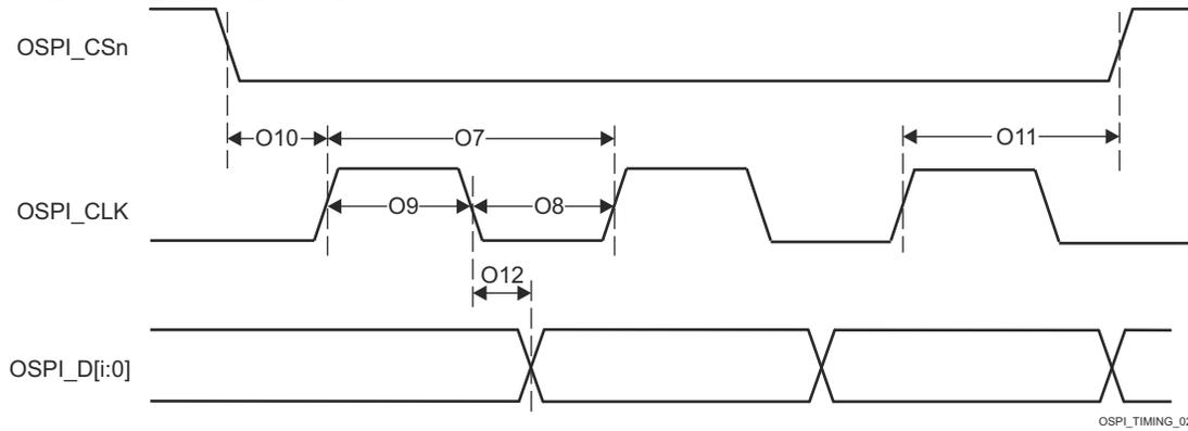
図 6-94. OSPI0 のスイッチング特性 – PHY SDR モード
