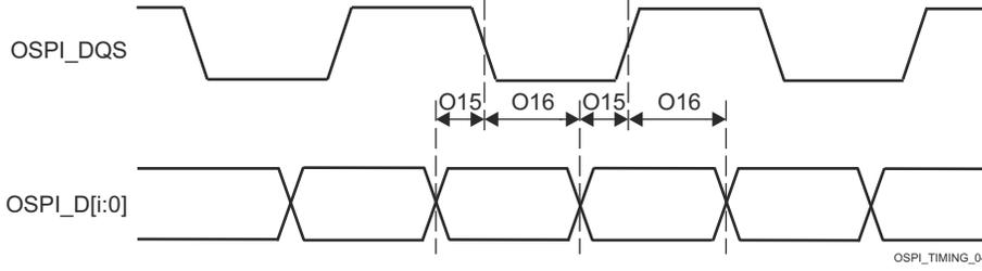
図 6-88. OSPI0 のタイミング要件 – PHY データ トレーニング、DQS 付き DDR
