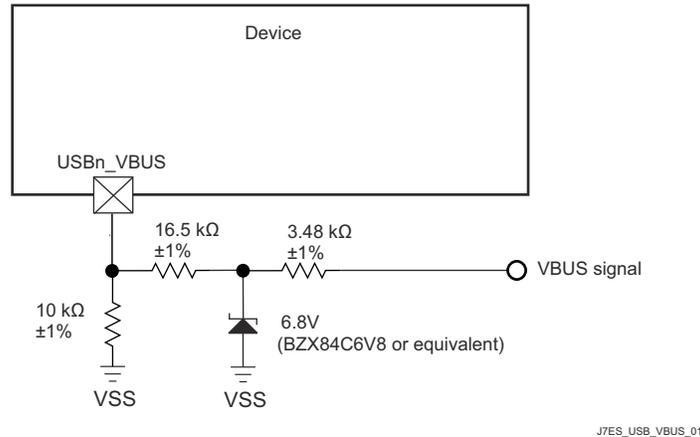
図 8-4. USB VBUS 検出分圧器 / クランプ回路
