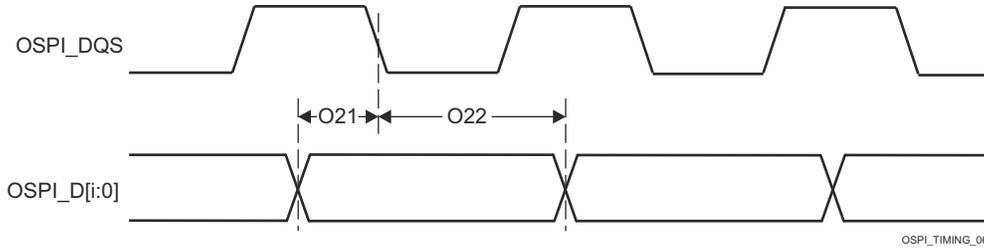
図 6-89. OSPI0 のタイミング要件 – PHY データ トレーニング、外部ボード ループバック付き SDR
