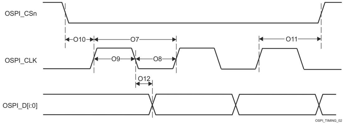
図 6-91. OSPI0 のスイッチング特性 - PHY SDR データ トレーニング
