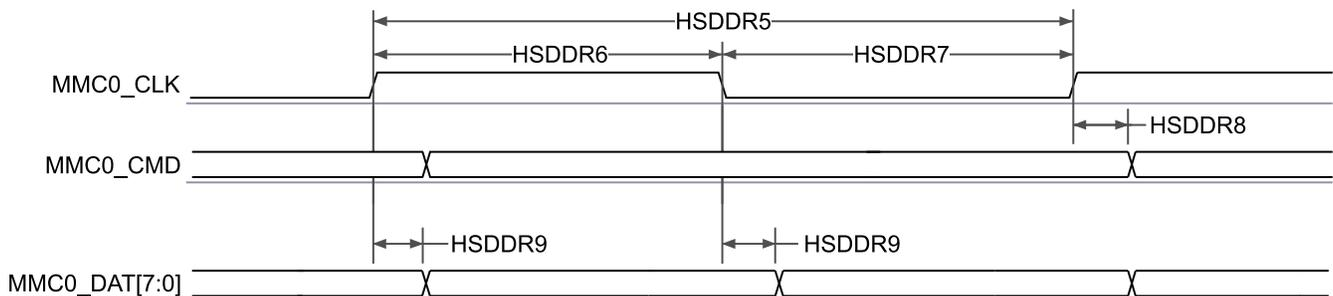
図 6-72. MMC0 – 高速 DDR モード – 送信モード
