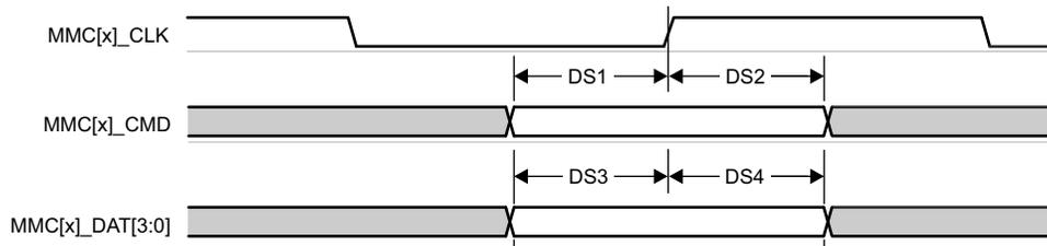
**図 6-76. MMC1/MMC2 – デフォルト速度 – 受信モード**
