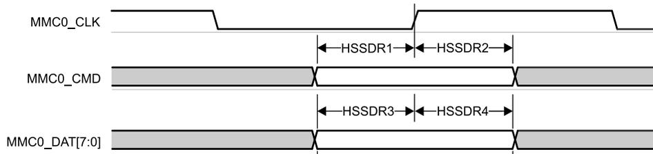
図 6-69. MMC0 – 高速 SDR モード – 受信モード
