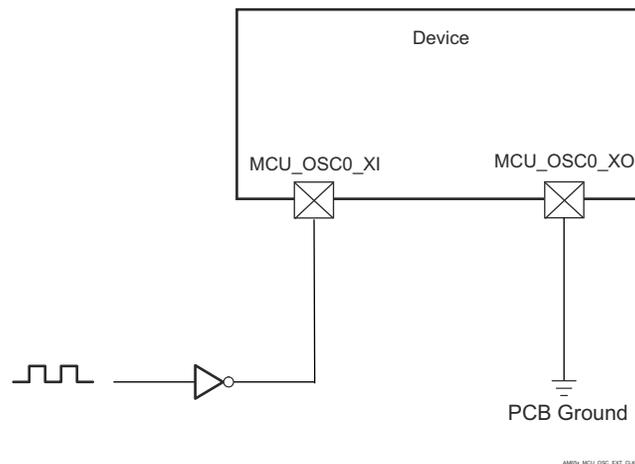
図 6-20. 1.8V LVCMOS 互換クロック入力
