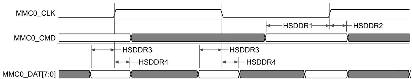
図 6-71. MMC0 – 高速 DDR モード – 受信モード
