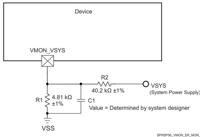
図 8-5. システム電源監視分圧回路
