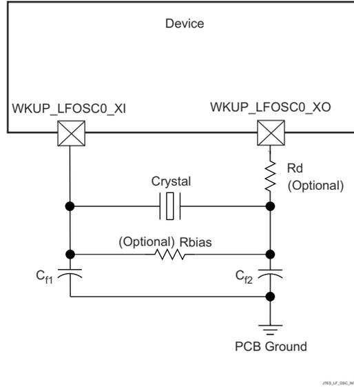
図 6-21. WKUP\_LFOSC0 水晶振動子の実装
