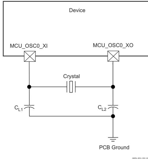
図 6-16. MCU\_OSC0 水晶振動子の実装
