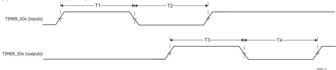
図 6-101. タイマのタイミング要件およびスイッチング特性
