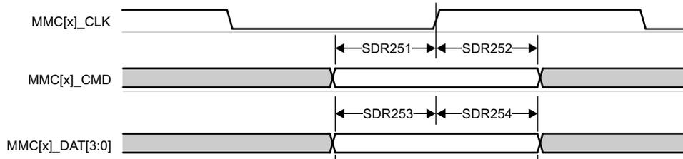
図 6-82. MMC1/MMC2 – UHS-I SDR25 – 受信モード
