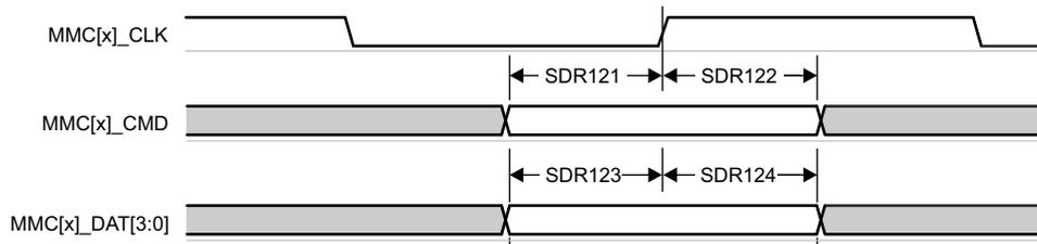
図 6-80. MMC1/MMC2 – UHS-I SDR12 – 受信モード
