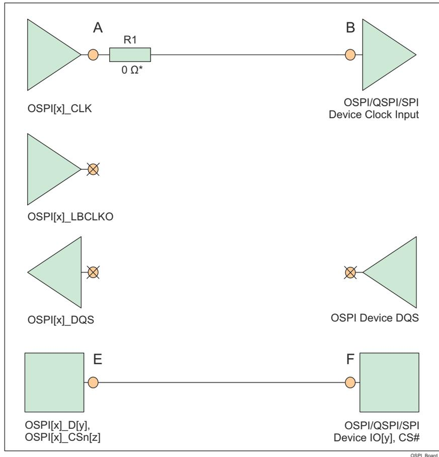
\* 0Ω 抵抗 (R1) は、OSPI[x]\_CLK ピンのできるだけ近くに配置して、必要に応じて微調整するためのプレースホルダです。
