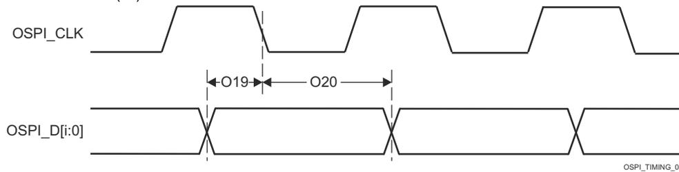
**図 6-97. OSPI0 のタイミング要件 – タップ SDR、ループバックなし**
