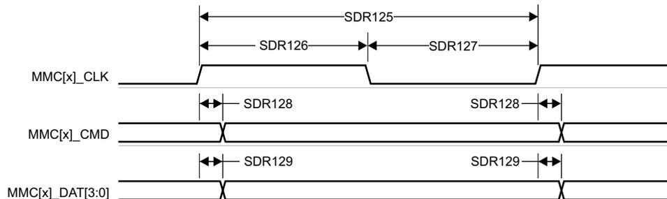
図 6-81. MMC1/MMC2 – UHS-I SDR12 – 送信モード
