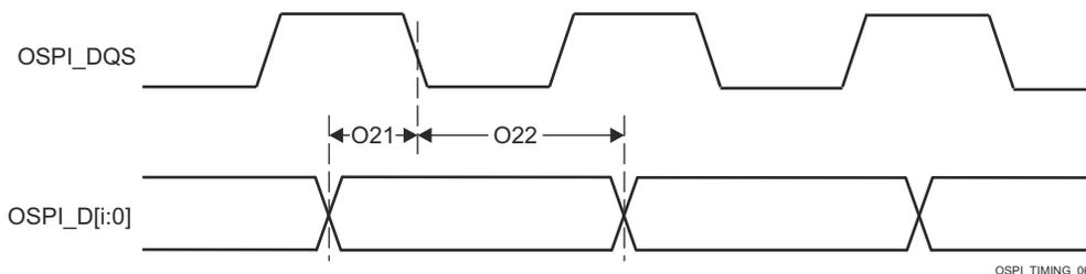
図 6-93. OSPI0 のタイミング要件 – 外部ボード ループバック付き PHY SDR
