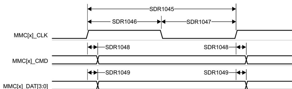
**図 6-86. MMC1/MMC2 – UHS-I SDR104 – 送信モード**
