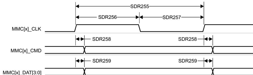
図 6-83. MMC1/MMC2 – UHS-I SDR25 – 送信モード
