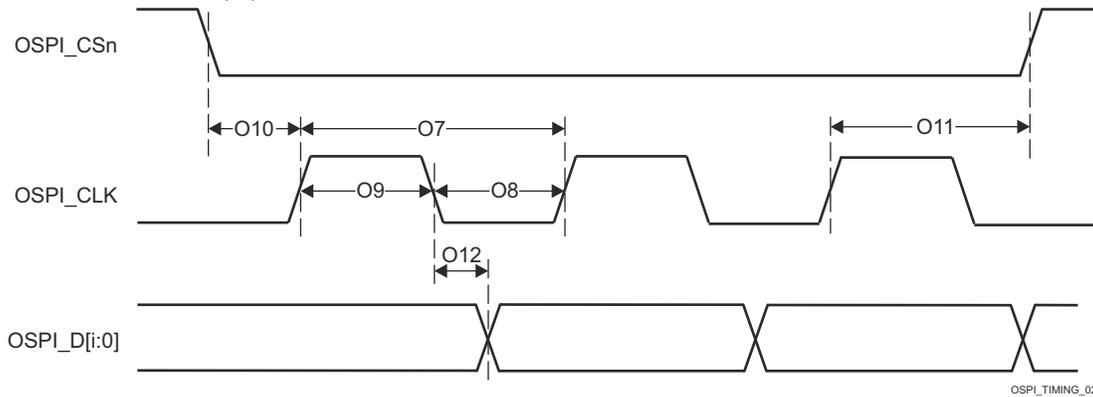
図 6-98. OSPI0 のスイッチング特性 – タップ SDR、ループバックなし
