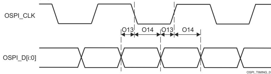
**図 6-99. OSPI0 のタイミング要件 – タップ DDR、ループバックなし**
