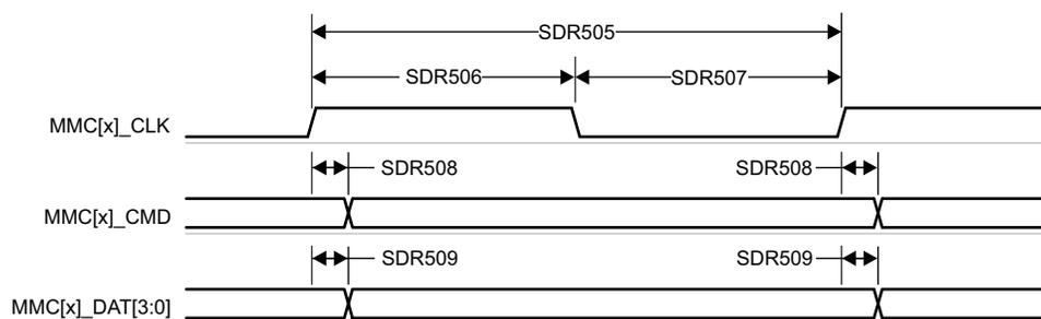
**図 6-84. MMC1/MMC2 – UHS-I SDR50 – 送信モード**
