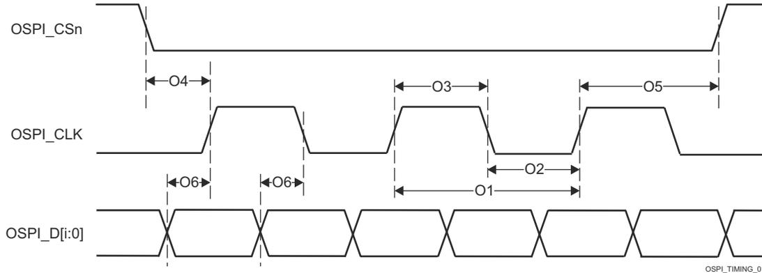
図 6-96. OSPI0 のスイッチング特性 – PHY DDR モード
