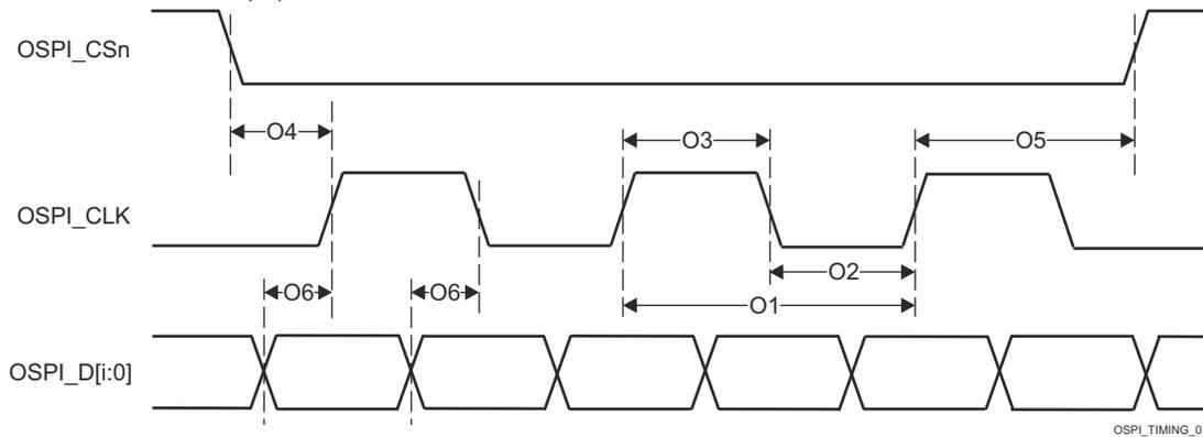
図 6-100. OSPI0 のスイッチング特性 – タップ DDR、ループバックなし
