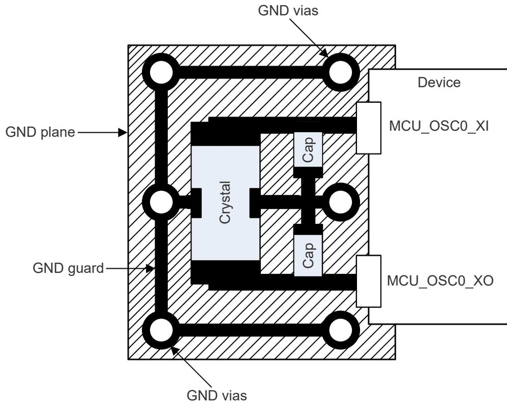
図 8-6. MCU\_OSC0 の PCB の要件
