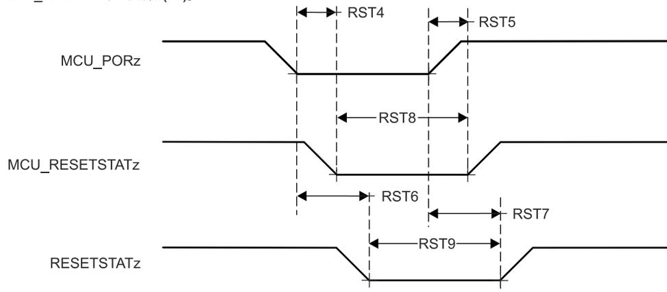
図 6-8. MCU\_RESETSTATz と RESETSTATz のスイッチング特性
