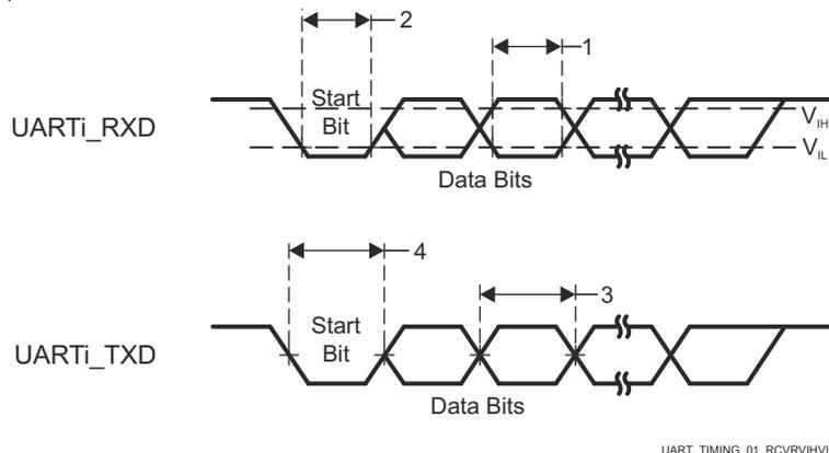
図 6-102. UART のタイミング要件およびスイッチング特性
