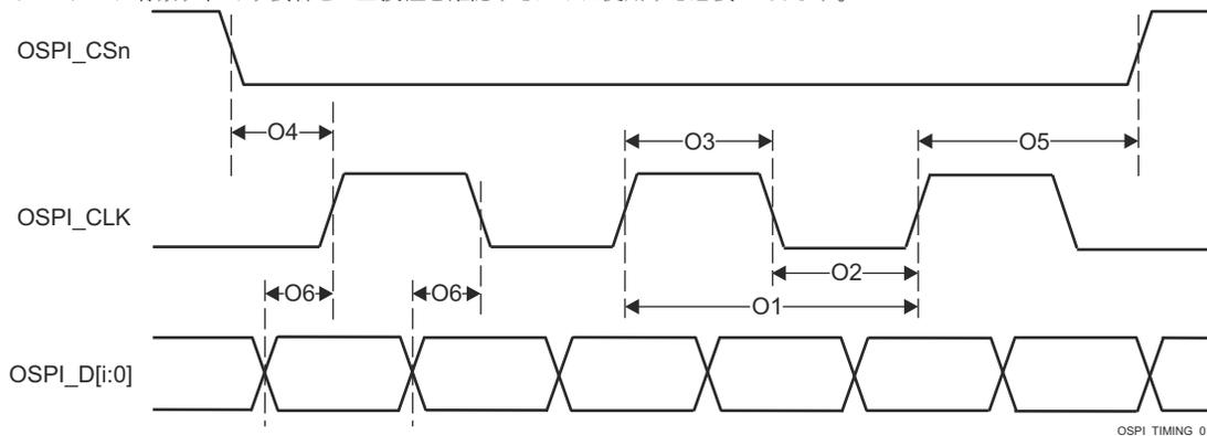
図 6-90. OSPI0 のスイッチング特性 - PHY DDR データ トレーニング
