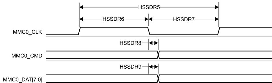
図 6-70. MMC0 – 高速 SDR モード – 送信モード
