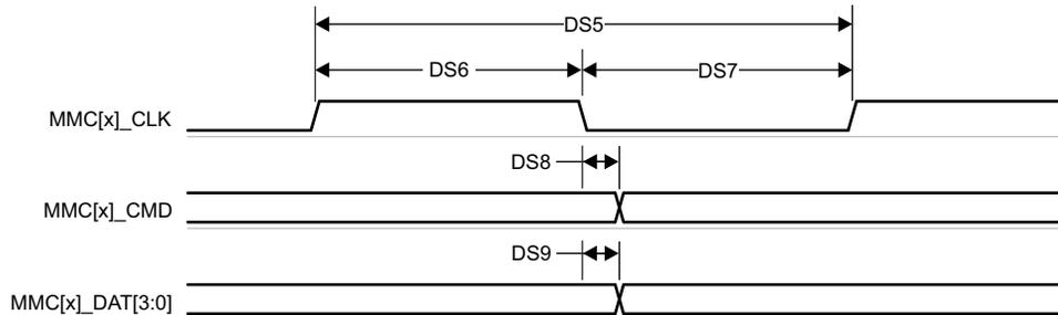
図 6-71. MMC0 – デフォルト速度 – 送信モード
