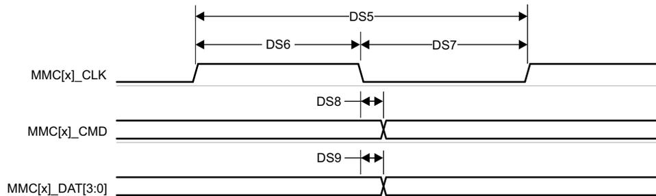
図 6-82. MMC1/MMC2 – デフォルト速度 – 送信モード
